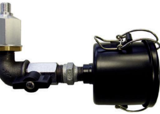
Le valvole per gas-ballast impediscono l'imbrattamento dell'olio della pompa causato dalla condensazione dei vapori. L'emulsione di acqua e olio prodottasi incide negativamente sull'azione della pompa o ne provoca l'arresto. La valvola permette ad una quantità di aria esterna dosata (il gas-ballast) di penetrare nella camera di compressione della pompa. Il mescolarsi dell'aria aspirata saturo e dell'aria esterna non satura blocca la condensazione.
